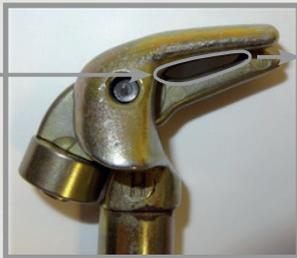
Unbearbeitete Standardrolle, schlechte Konturanpassung. (kein angedrehter Radius)
